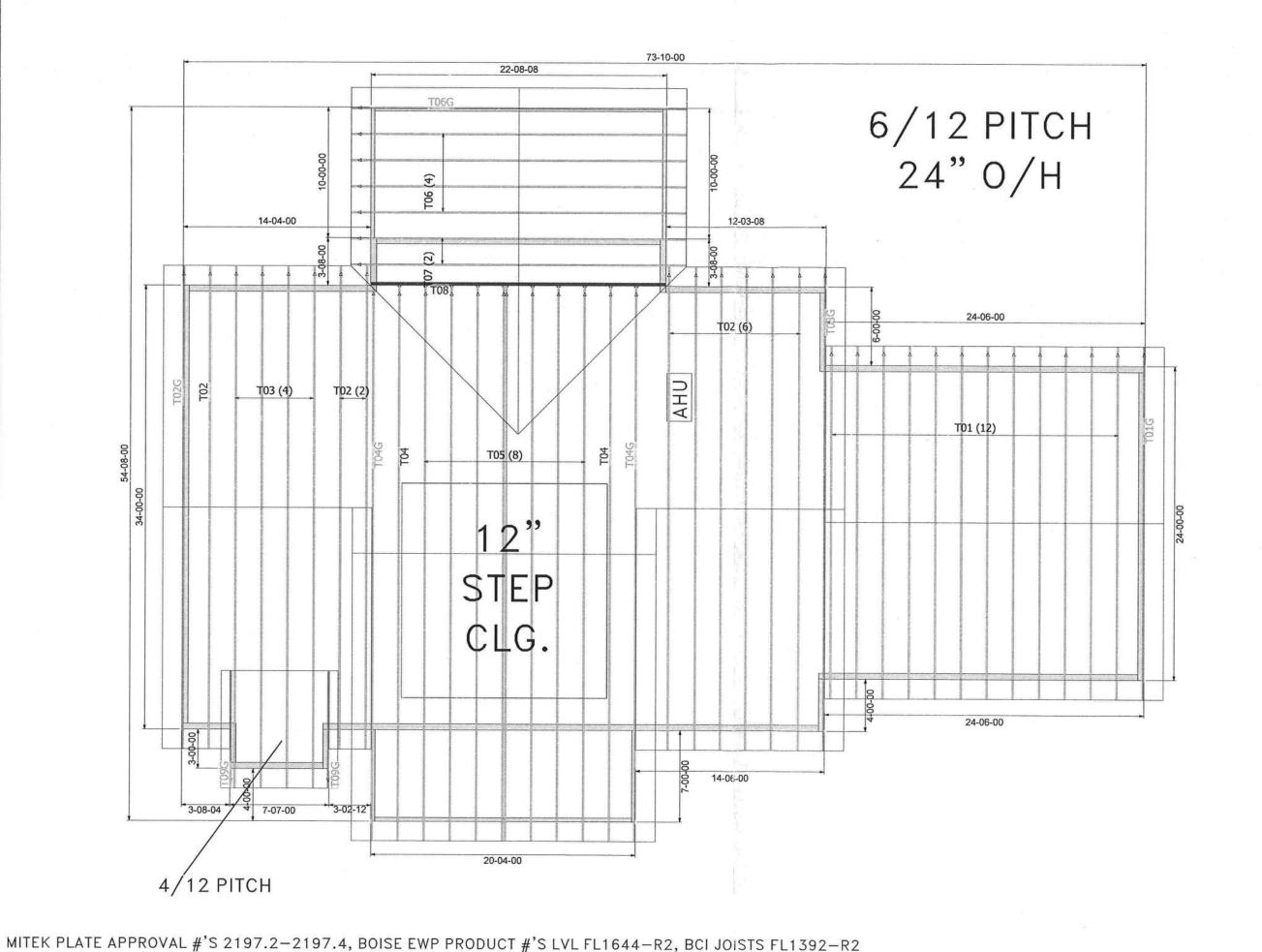
THE ARROW HEAD AT THE END OF THE TRUSS ON THE TRUSS PLACEMENT PLAN (LAYOUT) CORRESPONDS WITH THE LEFT SIDE OF THE INDIVIDUAL TRUSS DRAWING, USE THIS AS AN DRIENTATION GUIDE WHEN SETTING THE TRUSSES ON THE STRUCTURE.
