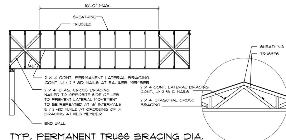
TYP, PERMANENT TRUSS BRACING DIA,
