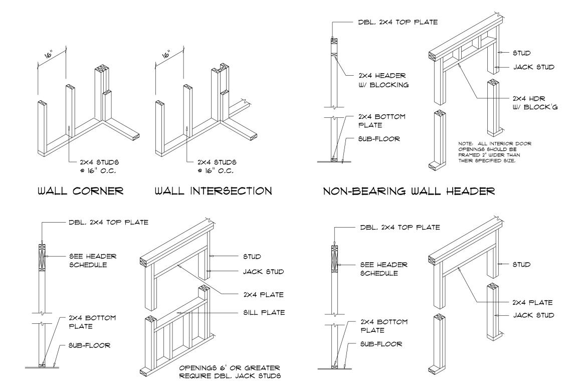
TYPICAL WINDOW HEADER BEARING WALL HEADER
