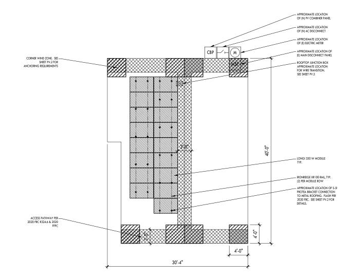
PHOTOVOLTAIC MODULE LAYOUT & ROOF PLAN
