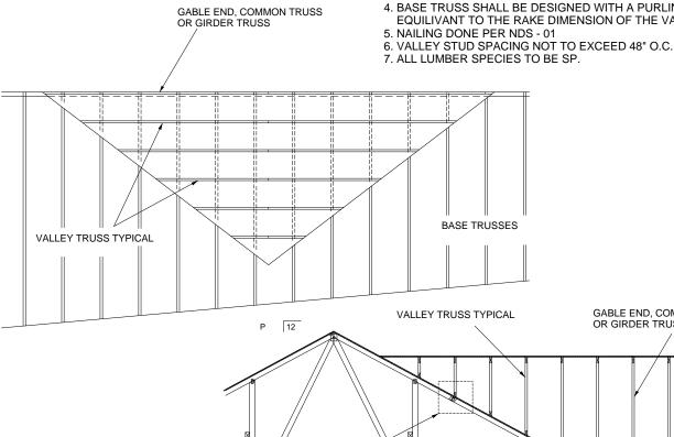
SEE DETAIL A BELOW (TYP.) GABLE END, COMMON TRUSS OR GIRDER TRUSS
