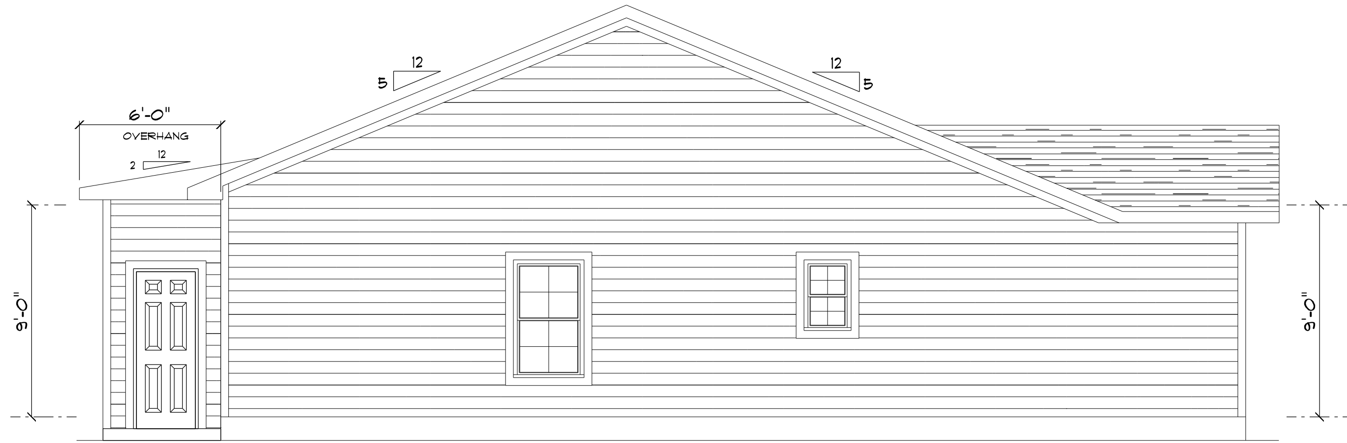
LEFT ELEVATION SCALE: 1/4" = 1'-0"
