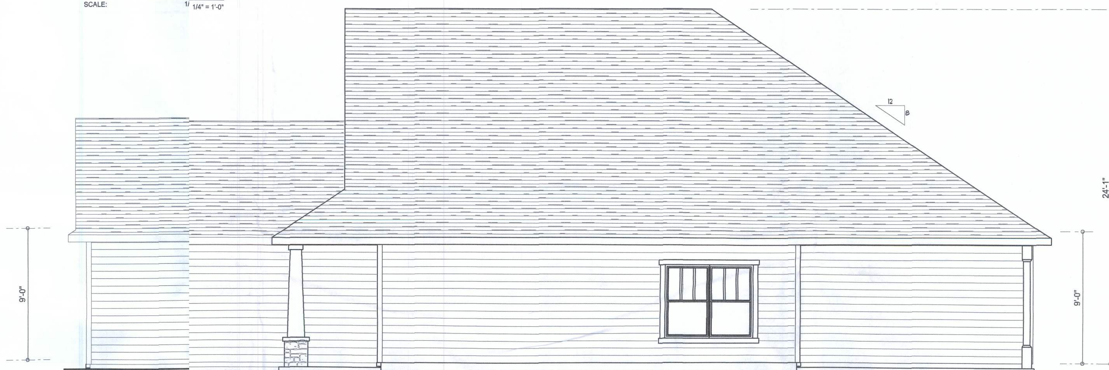
RIGHT ELEVATION SCALE: 1/4" = 1'-0"
