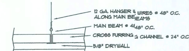
H DRYWALL CEILING SCALE: 3" = 1'-0"
