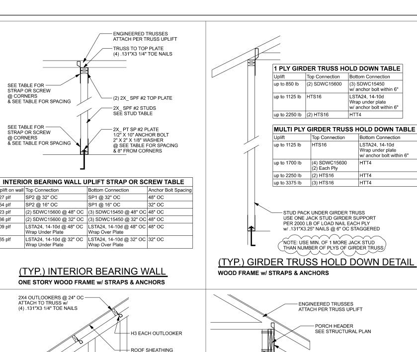
PLATE NAILED TO TRUSS
