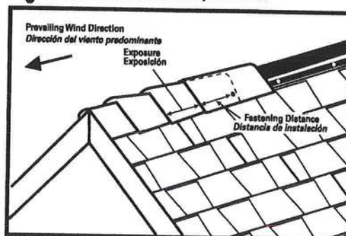
Fig. 8 Hip & Ridge Application Instalación de caballetes y cumbreras
