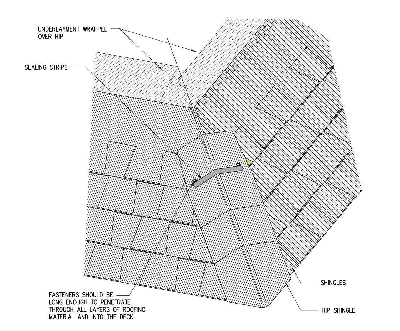
6 SHINGLE ROOF HIP / RIDGE DETAIL SCALE: N.T.S
