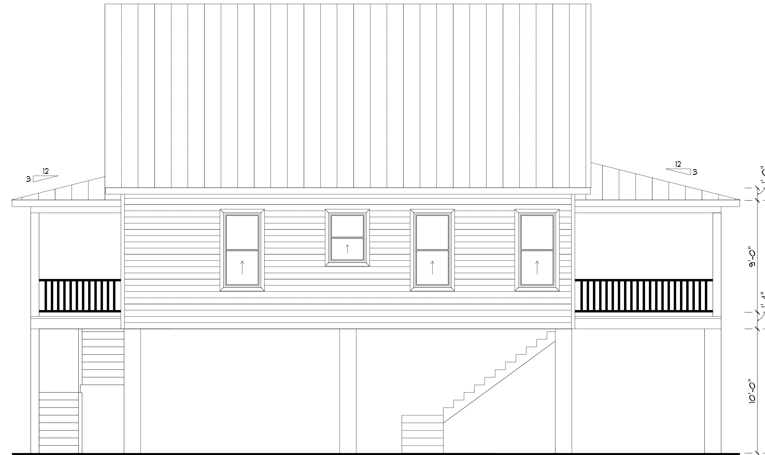
RIGHT ELEVATION SCALE: 1/4" = 1'-0"
