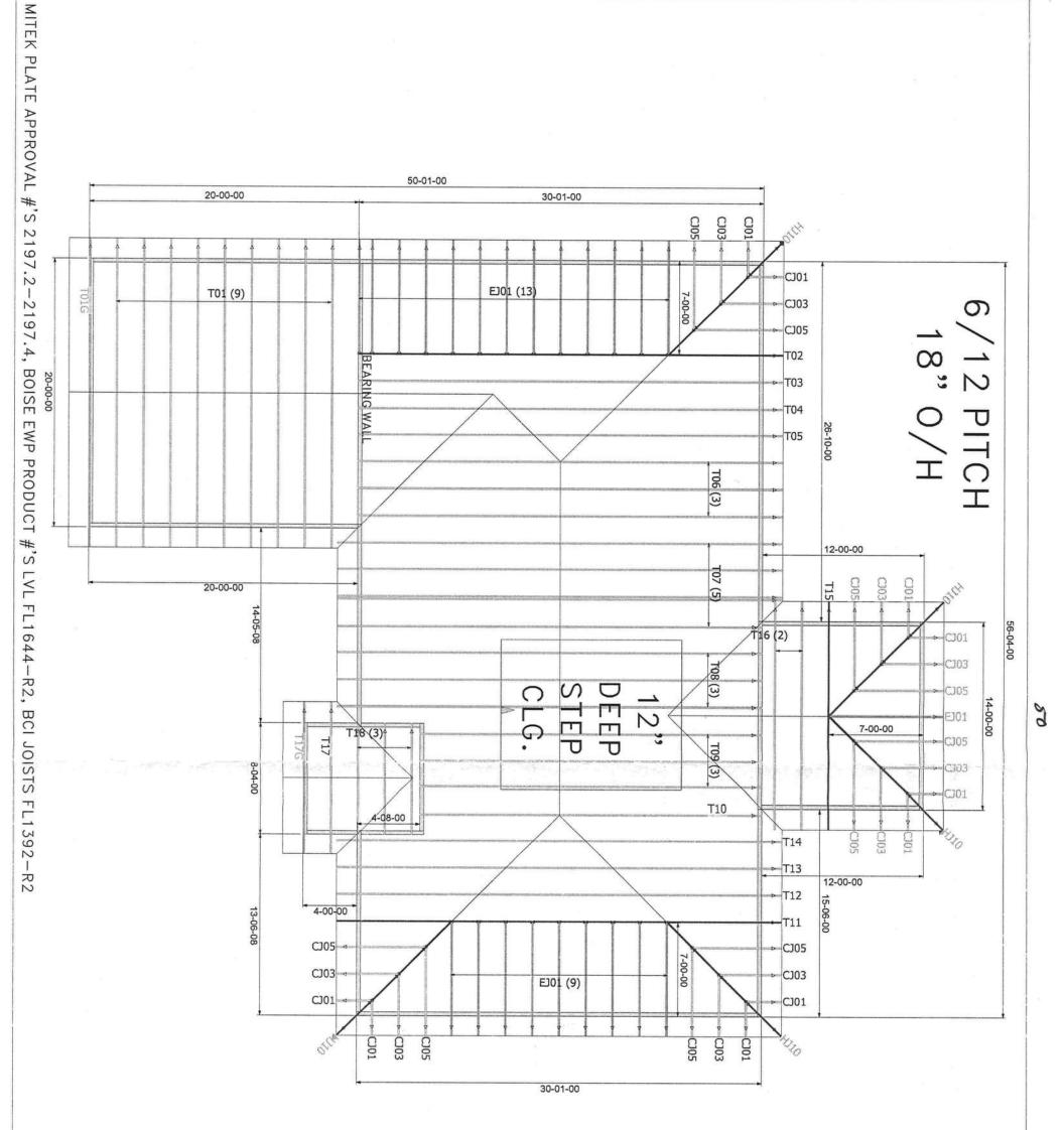
THE ARROW HEAD AT THE END OF THE TRUSS ON THE TRUSS ON THE TRUSS PLACEMENT FLAN (LAYOUT)
