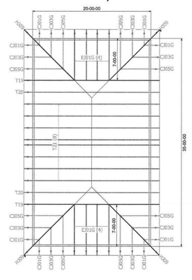
THE ARROW HEAD AT THE END OF THE TRUSS ON THE TRUSS PLACEMENT PLAN (LAYOUT) CORRESPONDS WITH THE LEFT SIDE OF THE INDIVIDUAL TRUSS DRAWING, USE THIS AS AN DRIENTATION GUIDE WHEN SETTING THE TRUSSES ON THE STRUCTURE.
