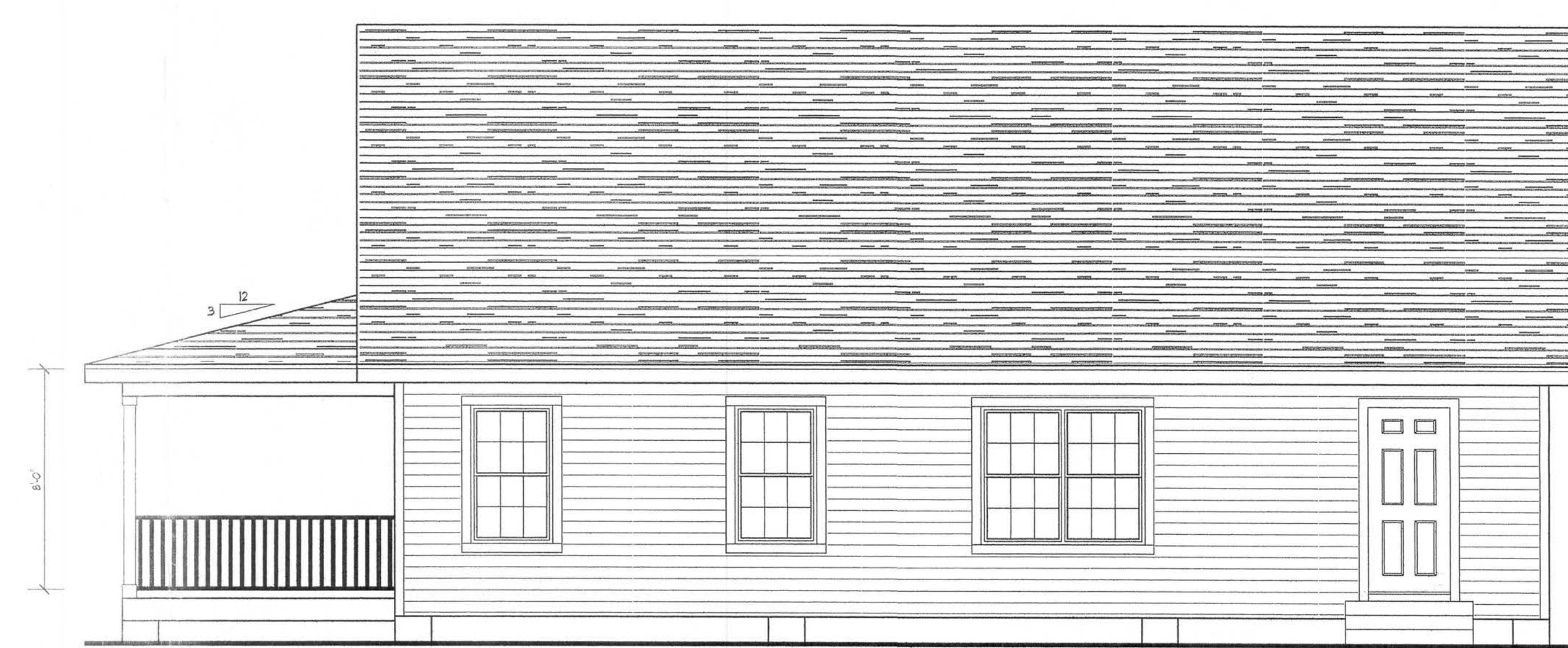
RIGHT ELEVATION SCALE: 1/4" = 1'
