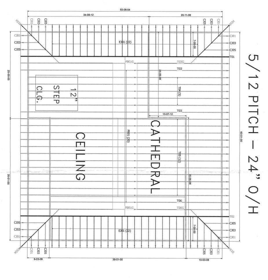
THE ARROW HEAD AT THE EXID OF THE TRUSS ON THE TRUSS PLACEMENT PLAN (LAYOUT)
