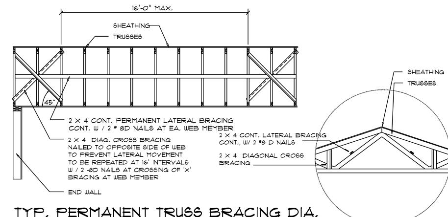
TYP, PERMANENT TRUSS BRACING DIA,
