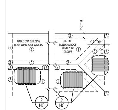
TYPICAL COLLECTOR PITCHED ROOF LAYOUT - WIND ZONES - SCHEDULE - PLAN/
