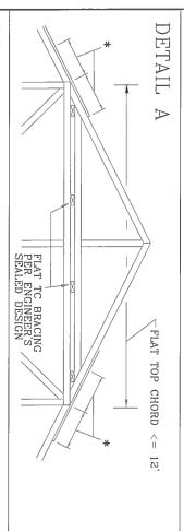
PIGGYBACK CAP TRUSS TOENAILED TO ALL TOP CHORD BRACING WITH (2) 10d COMMON (0.148"x3") NAILS.
