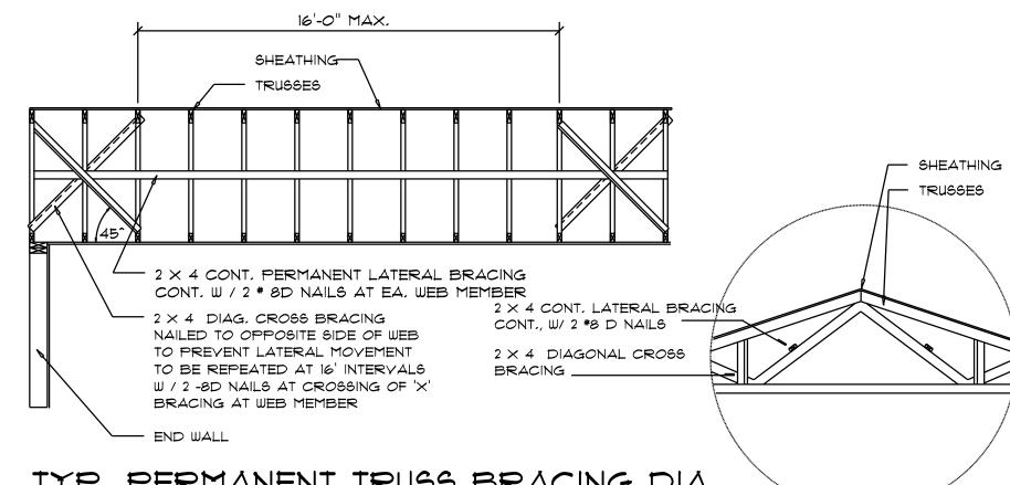
TYP, PERMANENT TRUSS BRACING DIA.
