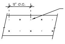
NAIL PLYWOOD FLITCH BEAM TOGETHER W/ 16d NAILS STAGGERED TOP AND BOTTOM, EACH FACE
