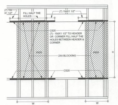
THIS DETAIL IS INTENDED TO BE USED ONLY FOR NAROW SHEARWALL SEGMENTS AS SPECIFIED ON THE PLAN. THE PIER BESIDE THE OPENING MUST MEET THE ASPECT RATIO REQUIREMENT H/W < 3.5:1 WHERE H IS THE PIER HEIGHT. FOR WINDOWS NOT GREATER THAN 2' HIGHT OR 5' WIDE THE WIDTH OF THE OPENING MAY BE INCLUDED AS FULL HEIGHT SHEARWALL IN ADDITION TO THE PIER WIDTH WHEN STRAPPED ACCORDING TO THIS DETAIL.
