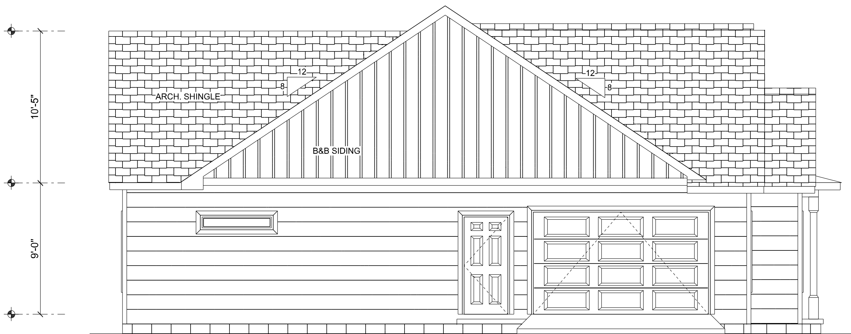
LEFT ELEVATION SCALE: 1/4" = 1'-0"
