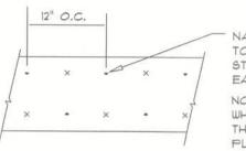
NAIL PLYWOOD FLITCH BEAM TOGETHER W/ 16d NAILS STAGGERED TOP AND BOTTOM, EACH FACE
